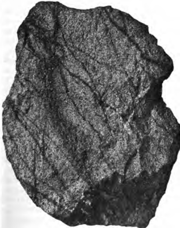
Fig. 15. Zinnerzgänge und Greisenzonen im Granit von Altenberg.
